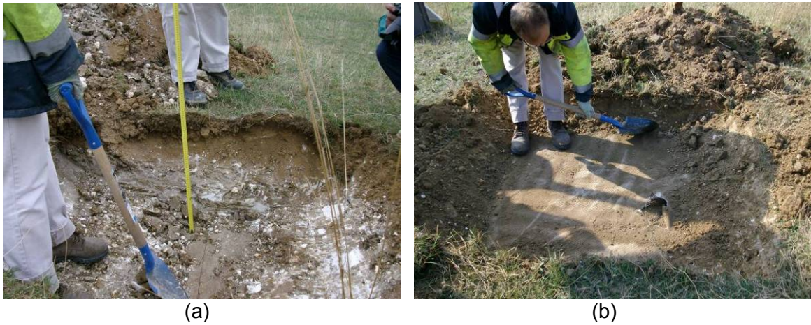
Figure 1. Vue de l'épaisseur de sol sur le dessus du géocomposite de drainage couvrant le GSB : (a) point de prélèvement 3 ; et (b) au point de prélèvement 6.
