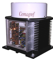
Figure 1. Vue générale du radar K2Pi
