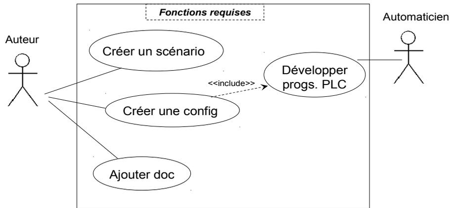
Figure 4. Cas d'utilisation lié à l'expert en automatisme
