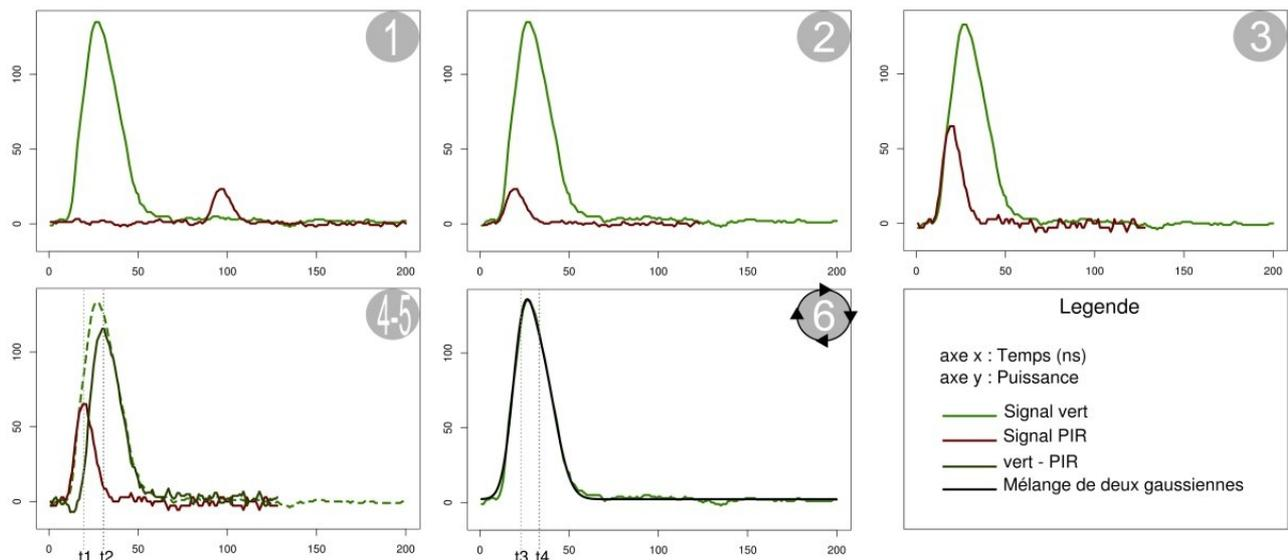
**Figure 6** : Description schématique de l'algorithme de traitement des formes d'ondes
