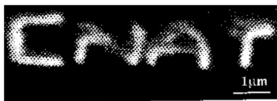
FIG. 16.14: LOP sur GeSbTe. Image SNOM en mode réflexion de lettres préalablement cristallisées par un éclairage en champ proche.
