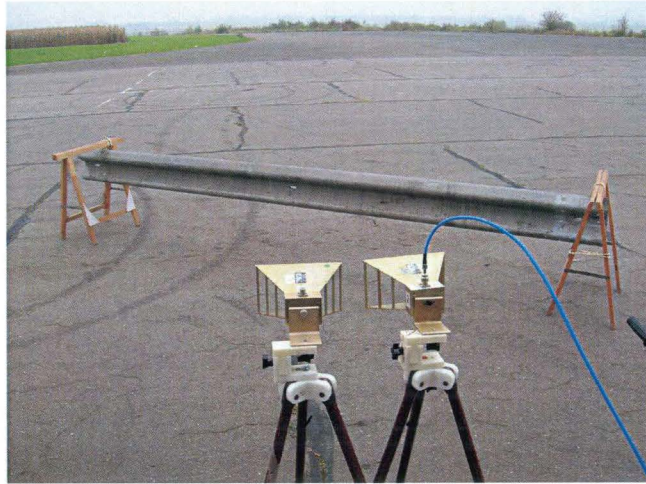
Photo IV.4: Mesures sur une glissière d'autoroute.
