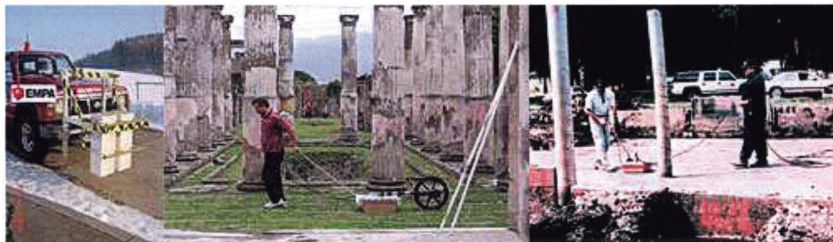
Photo II.2 : Exemples d'engagement de GPR, de gauche à droite : GPR monté sur un véhicule pour le contrôle de la chaussée, GPR engagé dans l'archéologie ici à Pompeï, recherche de corps enfouis sous une dalle de béton à l'aide d'un GPR
