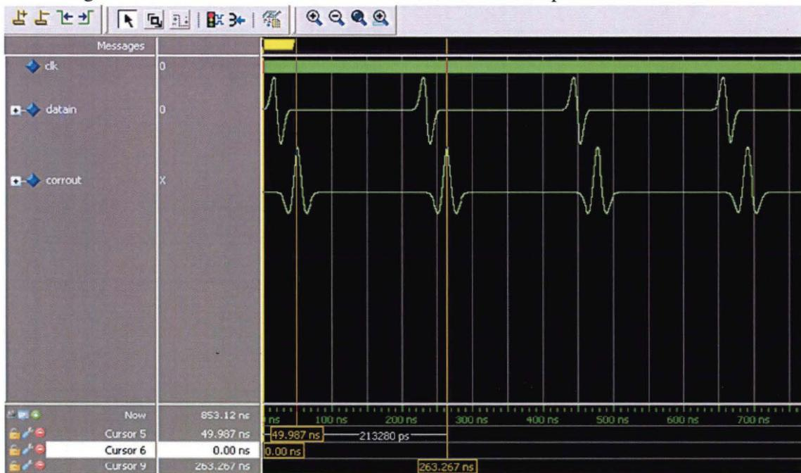
Figure V.18. Résultats théoriques de la corrélation implémenté en série (Modelsim).
