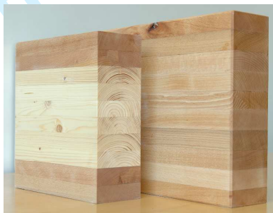
20 21 22 23 24 25 26 27 28 29 30 31 Abb. 1 Hybrides, mit Kernlamellen aus Nadelholz (links) und homogenes Buchenbrettschichtholz 32 (rechts)
