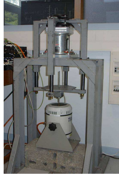
Fig. 3. Suspension active à actionneur inertiel (photo)
