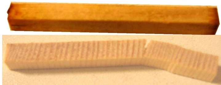
Figure 5 : haut : pénétration du couplant dans une éprouvette d'épicéa en direction longitudinale ; bas : rupture d'une éprouvette d'épicéa en direction quasi radiale, pour un serrage comparable à celui appliqué sur les éprouvettes longitudinales
