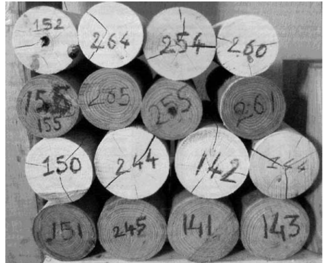
Fig. 3 Photography of the end of paired logs after hot oil bath treatment, then drying (odd samples), or direct natural drying (even samples) Abb. 3 Stirnseiten der Stammpaare nach einer Heißbehandlung mit anschließender Trocknung (Proben mit ungeraden Nummern) oder unmittelbarer Lufttrocknung (Proben mit geraden Nummern)
