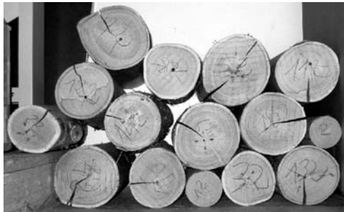
Fig. 10 Paired logs series naturally dried to 12% moisture content Abb. 10 Unbehandelte, auf 12% Holzfeuchte getrocknete Vergleichsproben
