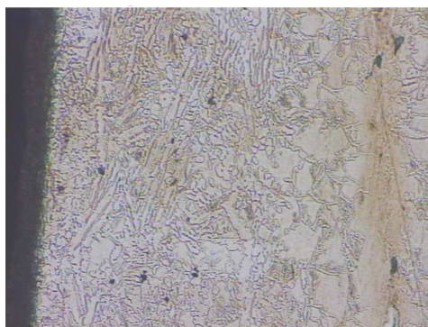
500 \mu\text{m} Structure ferrito-perlitique
