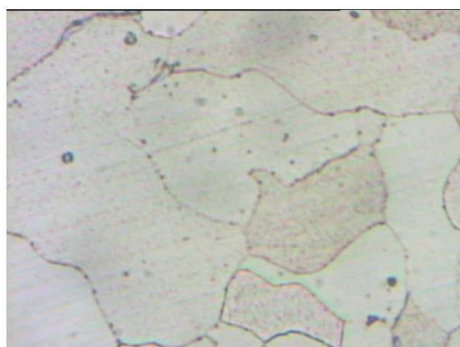
250 μm Structure ferritique
