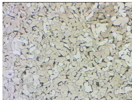
500 \mu\text{m} Structure ferritique
