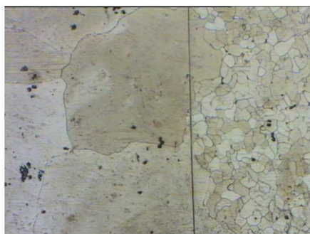
500 \mu\text{m} Structure ferritique avec croissance exagérée de certains grains
