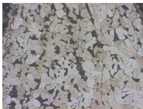
250 \mu\text{m} Structure ferritique avec précipités de cémentite
