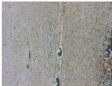
500 \mu\text{m} Structure ferritique, avec liseré blanc matérialisant la soudure
