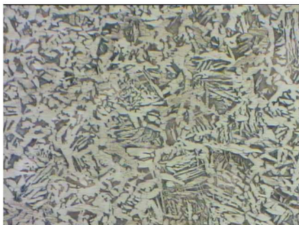
500 \mu\text{m} Structure ferrite-perlitique au bord de la barre
