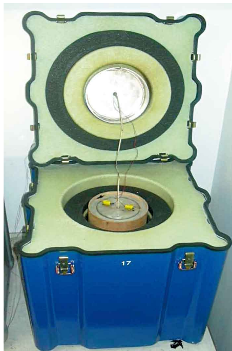
figure 2 a) vue du calorimètre à étalonner avec sa résistance chauffante ; b) vue agrandie.
