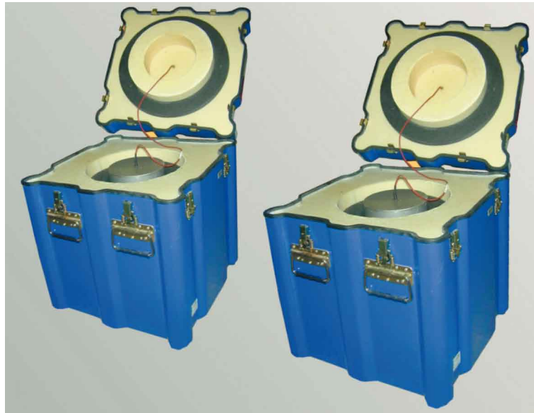
figure 1 Calorimètres quasi adiabatiques pour bétons (QAB).
