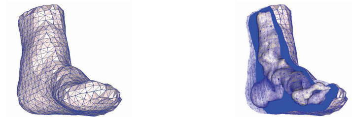
Fig. 1. Modèle biomécanique EF du pied ( gauche ) et vue interne des structures osseuses modélisées ( droite ).
