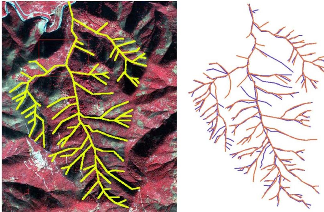
Figure 3. Extraction de réseau hydrographique sur image Quickbird des Cévennes et comparaison au réseau IGN, projet ORFEO-CNES, bassin de Peyrolles (4 km<sup>2</sup>), [8].
