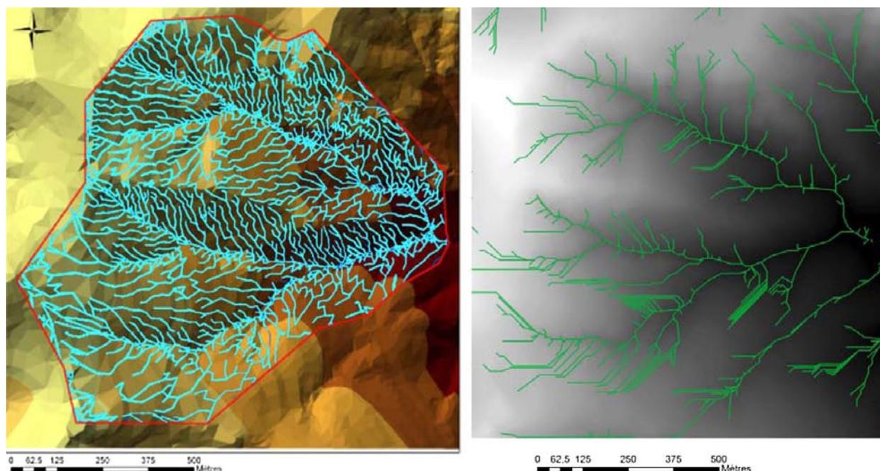
Figure 1. Alternatives TIN ou raster pour calculer les réseaux à l'amont des bassins. Test sur le bassin de Tourgueille, Cévennes (1 km<sup>2</sup>).
