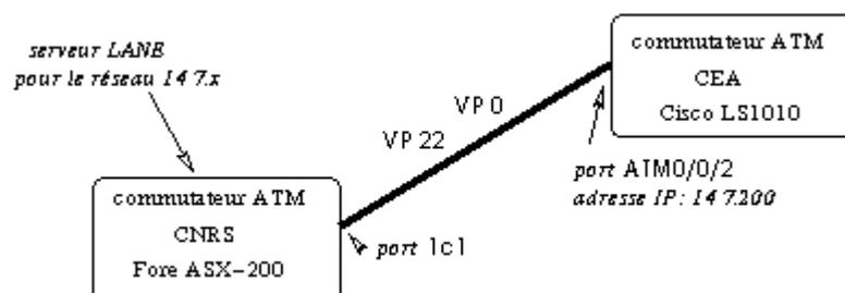
1. On crée le VP22 dans les 2 sens (exemple de syntaxe côté Fore) :
