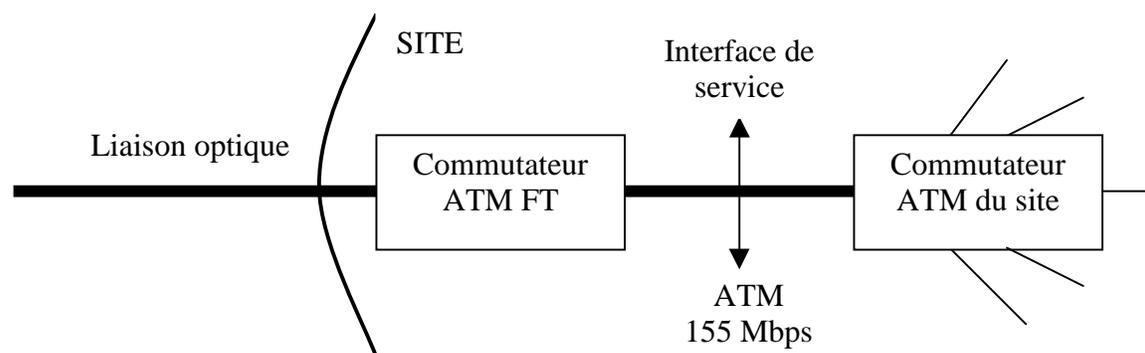
Sur cette interface de service le site connecte son propre commutateur ATM avec des stations ATM et un **routeur ATM-Ethernet permettant d'accéder au réseau de production du site** (en grisé sur le schéma suivant). Tous les sites ont en interne un réseau de production de type campus, Ethernet commuté à 100 M et parfois FDDI.
