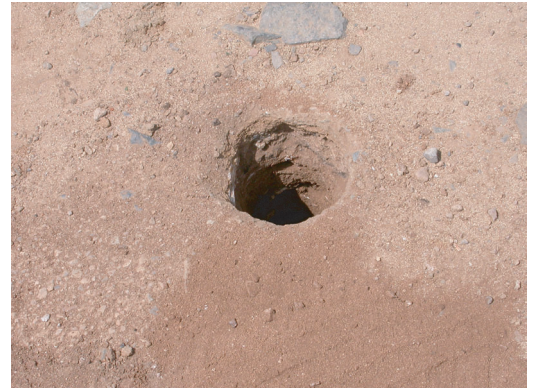
Vue d'un sondage à la tarière
