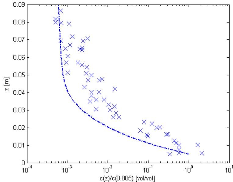
Figure 2. Profil de concentration moyenne sur un fond de rides pour des particules grosses ( $w_s=6.1\text{cm/s}$ ). Courbe : solution de l'éq. (7) avec l'éq. (14) ; ( $\lambda=1$ ) ;  $L_w=0.05\text{m}$  ,  $z_l=0.005\text{m}$  ;  $w_m(z_l)=0.025\text{m/s}$ .  $\times$ : mesures.
