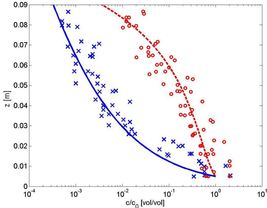
Figure 4. Profil de concentration moyenne sur un fond de rides pour des petites particules (o)  $w_s=0.65\text{cm/s}$  et des grosses ( $\times$ )  $w_s=6.1\text{cm/s}$  (mesures (McFETRIDGE & NIELSEN, 1985)). Courbes : solutions de (3) avec  $\alpha_{Dt}=0.025\text{m/s}$ . Trait plein :  $h_{Dt}=0.24\text{m}$ . Tirets :  $h_{Dt}=0.022\text{m}$ .
