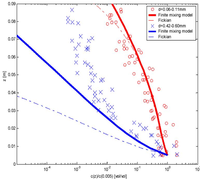
Figure 1. Profil de concentration moyenne sur un fond de rides pour des petites particules (o)  $w_s=0.65\text{cm/s}$  et des grosses particules ( $\times$ )  $w_s=6.1\text{cm/s}$  (symboles mesures). Traits pleins: solution de (7) avec  $l_m=\lambda z$  ( $\lambda=1$ ) et  $z_l=0.005\text{m}$ ,  $w_m(z_l)=0.025\text{m/s}$ ,  $L_w=0.022\text{m}$ . tirets-pointillés, solution de l'éq. (3) (Figure d'après NIELSEN & TEAKLE, 2004).
