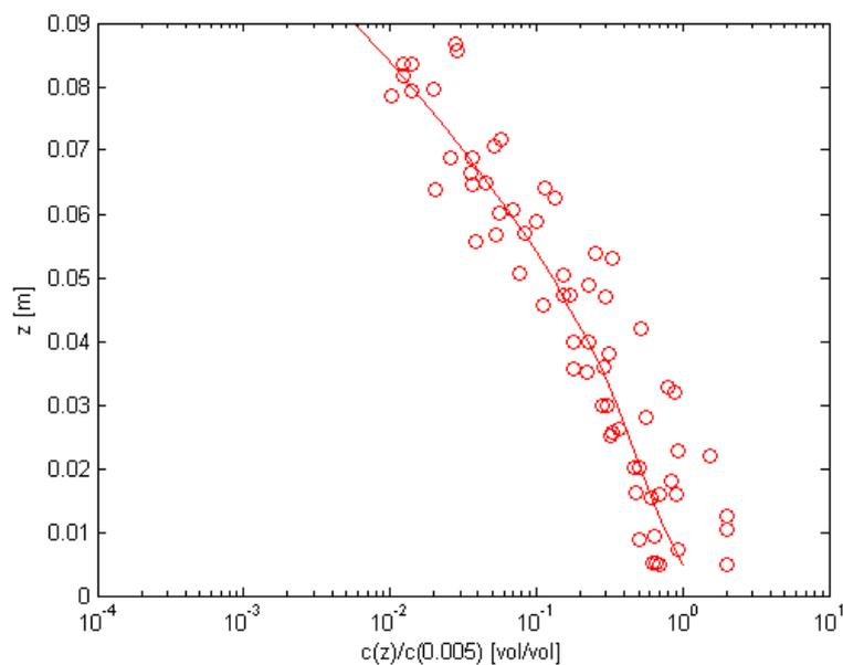
Figure 3. Profil de concentration moyenne sur un fond de rides pour des particules fines ( $w_s=0.65\text{cm/s}$ ). courbe : solution de l'éq. (7) avec l'éq. (15) ; ( $\lambda=1$ ) ;  $L_w=0.022\text{m}$  ,  $z_l=0.005\text{m}$  ;  $w_m(z_l)=0.025\text{m/s}$ .  $o$ : mesures.
