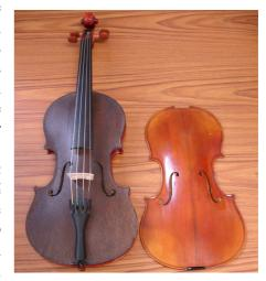
des mesures vibro-acoustiques sur l'instrument en composites en situation de jeu confirment les remarques des luthiers. Une solution serait par exemple de coupler la fibre de lin à la fibre de carbone qui possède des facteurs de pertes très inférieurs.
