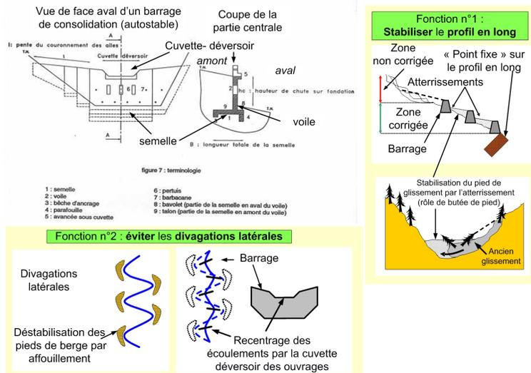
**Figure 2.** Composants et fonction des barrages de correction torrentielle de type consolidation
