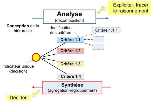
Figure 7. Principe de l'analyse multi-critère hiérarchique originale (AHP)
