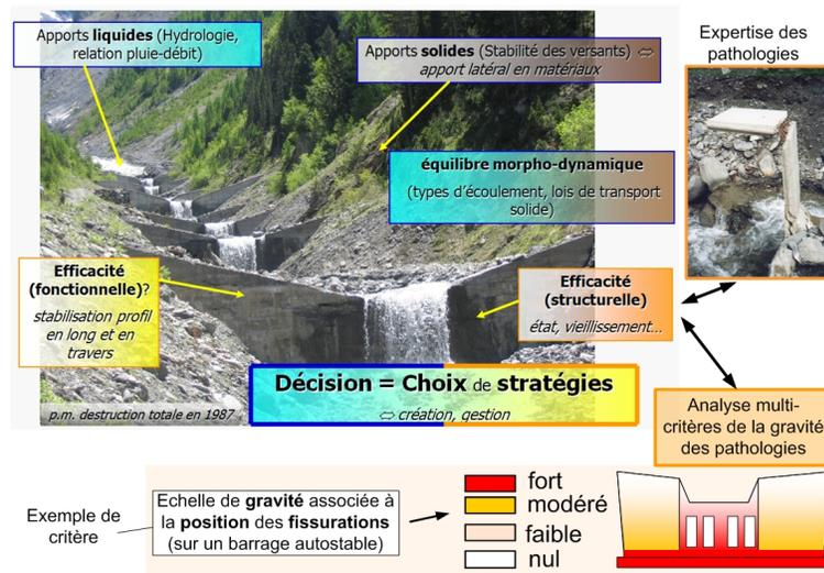
**Figure 3.** *Eléments du contexte décisionnel associé aux barrages de correction torrentielle*
