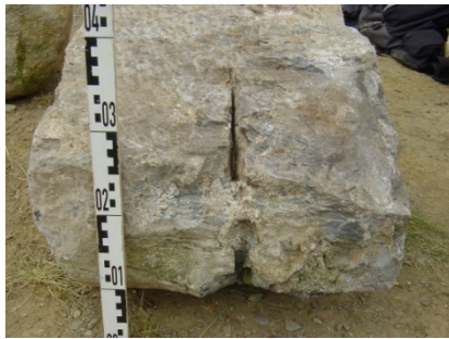
Bloc issu de la destruction du donjon Remarquez sur le côté l'essai pour le partager en deux non abouti à cause d'un écaillage du bloc visible en haut à droite
