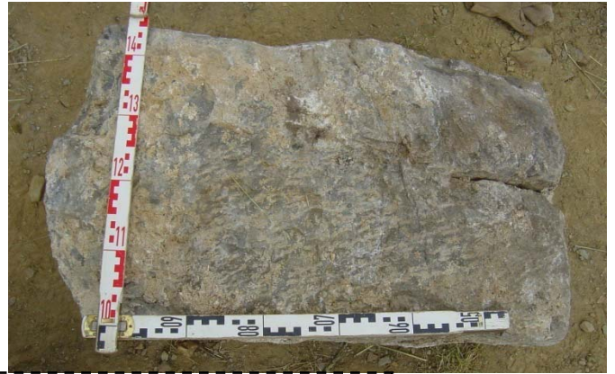
Bloc issu de la destruction du donjon Remarquez sur le côté l'essai pour le partager en deux non abouti à cause d'un écaillage du bloc visible en haut à droite
