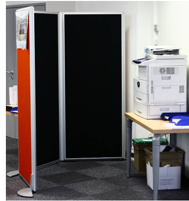
Figure 3 : exemple de cloisonnettes acoustiques disposées autour d'une imprimante
