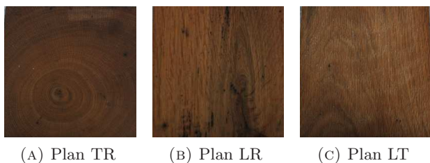
FIGURE 2 – Échantillons de bois découpés dans les trois plans caractéristiques du bois.
