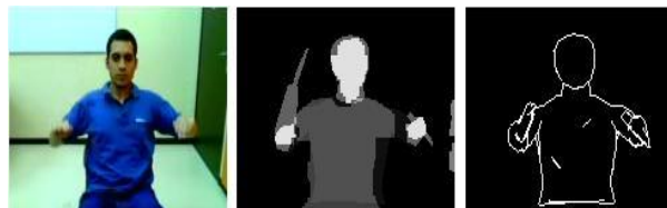
Fig. 2 : Correction du recalage sur les régions. Les images sont respectivement l'image acquise ; le modèle superposé sur l'image segmentée, avec un recalage incorrect du bras droit ; les contours occultants du modèle 3D dans la position finale avec recalage sur les contours.
