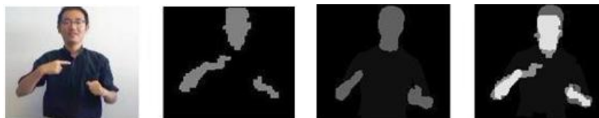
Fig. 1 : Précision limitée du recalage sur les régions : les images sont respectivement l'image acquise, puis segmentée, la projection du modèle 3D et enfin la superposition de la projection du modèle avec l'image segmentée. La pose du modèle 3D diffère de celle de l'acteur observé car le recalage sur les régions n'est pas précis.
