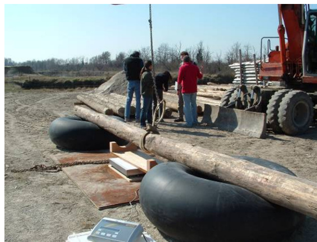
Figure 10 : Mesure du MOE dynamique sur poteaux.
