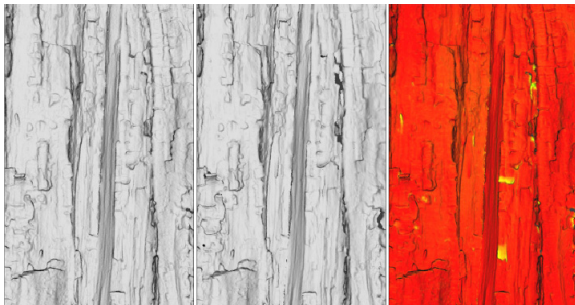
Figure 11 (b) : L'image en fausses couleurs montre, pour 2 balayages, les surfaces se détachant (en jaune) [16].
