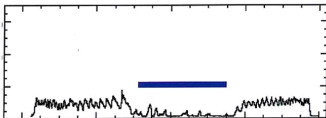
Figure 8 : Détection de pourriture par perçage dynamométrique.
