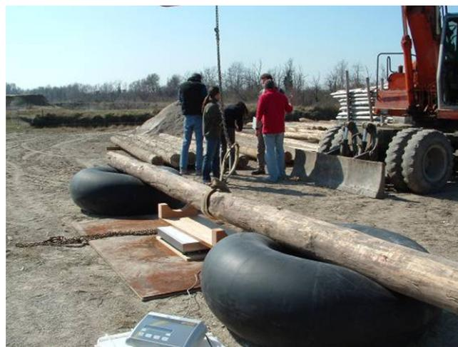
Figure 10 : Mesure du MOE dynamique sur poteaux.
