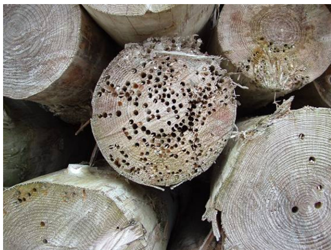
Figure 9 : Dégradations provoquées par des mollusques marins ( Teredo navalis ).
