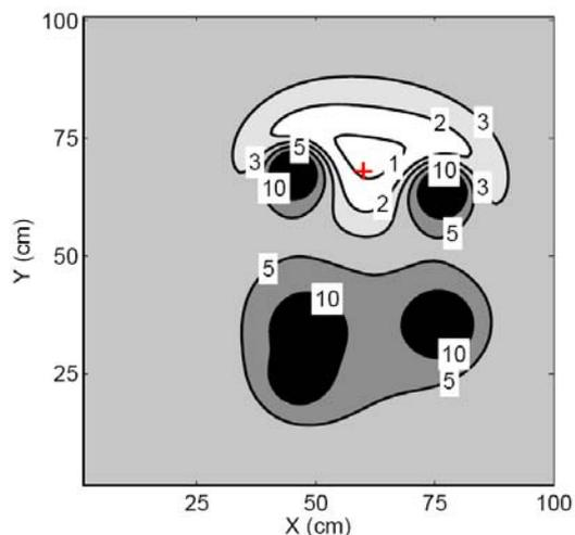
Figure 7 : carte de maximum de vraisemblance  $\chi_n^2$ , en ligne de niveau. La position réelle du défaut, repérée par une croix rouge, est incluse dans la zone prévue par LOCADIFF, c'est-à-dire la région où  $\chi_n^2 < 1$
