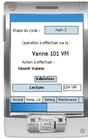
Figure 8 : Vue de la requête d'ouverture de la vanne 101VM sur le PDA du rondier
