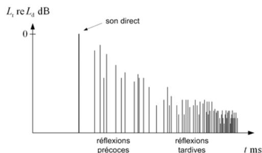
Figure 1 : Echogramme schématisique
