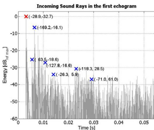
Figure 9 : Echogramme de la salle test
