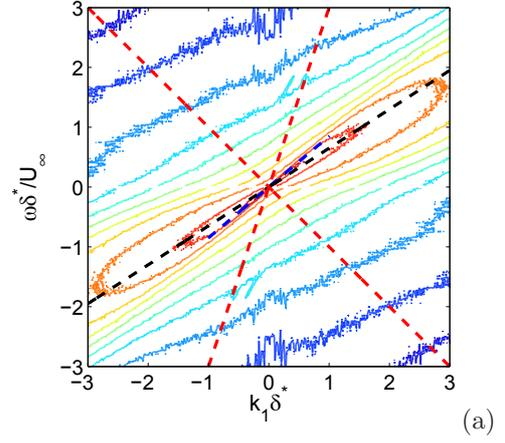
FIG. 8: Contours du logarithme du spectre fréquence-nombre d'onde  $\Phi_{pp}(k_1, 0, \omega)$  (19 contours entre -10 and -1 tous les 0.5). La ligne pointillée noire représente la relation  $k_c = \omega/U_c$  avec  $U_c = 0.6U_\infty$ , et la ligne pointillée bleue  $U_c = 0.85U_\infty$ . Les lignes rouges indiquent les nombres d'onde acoustiques convectés  $\kappa_0 = \omega/(U_\infty \pm c_\infty)$ .
