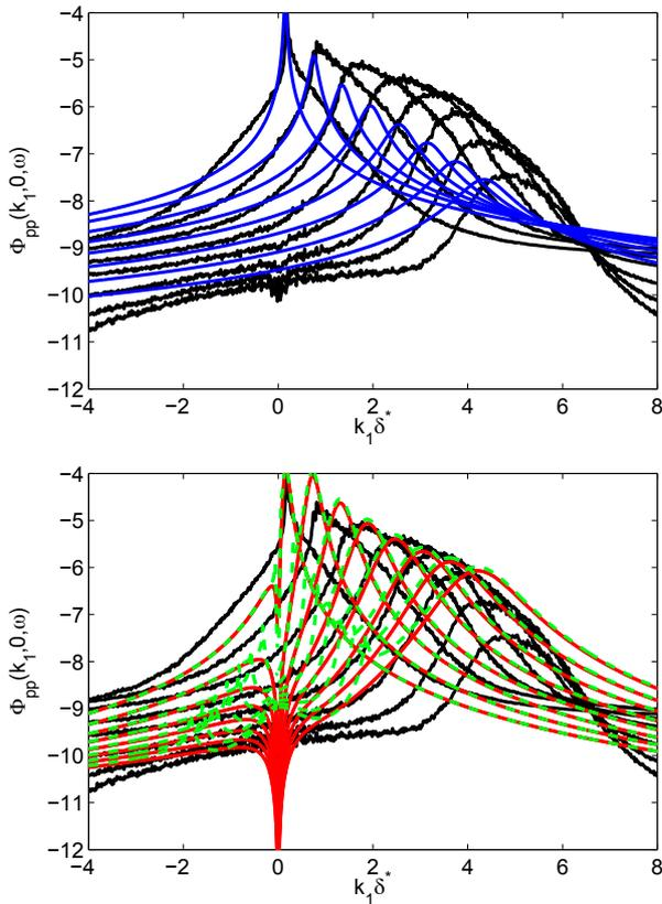
FIG. 9: Spectres fréquence-nombre d'onde pour fréquences successives  $\omega \delta^* / U_\infty = 0.127, 0.636, 1.145, 1.654, 2.164, 2.673, 3.182$  et  $3.691$  (—). En haut, comparaison avec le modèle de Corcos pour les mêmes fréquences avec  $\phi_{pp}(\omega)$  donné par le modèle de Goody (1) (—). En bas, comparaison avec le modèle de Chase standard (—) et étendu au domaine acoustique (— —).
