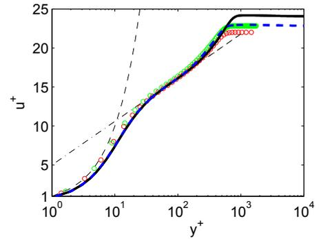
FIG. 1: Profil de la vitesse longitudinale en coordonnées de paroi à deux positions  $x_1/\delta_{\text{ref}}=73$  ( $\text{Re}_\theta=2229$ ) (—) et  $x_1/\delta_{\text{ref}}=41.5$  ( $\text{Re}_\theta=1551$ ) (- - -). On superpose quelques données de référence : DNS de Spalart à  $\text{Re}_\theta=1410$  ( $\circ$ ), DNS de Jimenez à  $\text{Re}_\theta=1551$  ( $\circ$ ).
