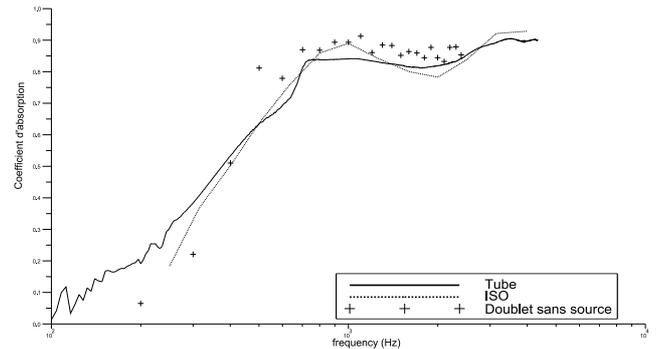
FIGURE 4 – Comparaison des méthodes ISO 13472-1, du doublet microphonique sans source et du tube d'impédance sur mousse polymère
