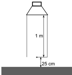
FIGURE 1 – Système de mesure de la méthode ISO 13472-1
