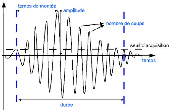
Figure 2 : Principaux paramètres temporels d'une salve d'émission acoustique.
