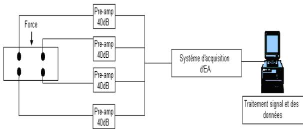
Figure 1 : Synoptique du système d'émission acoustique.
