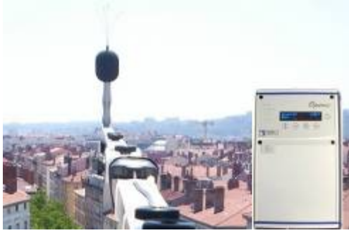
Figure 1 : système de mesure Oper@, pour la surveillance acoustique longue durée. L'utilisation couplée du logiciel OSSR permet de reconnaître les sources à l'origine des bruits mesurés.
