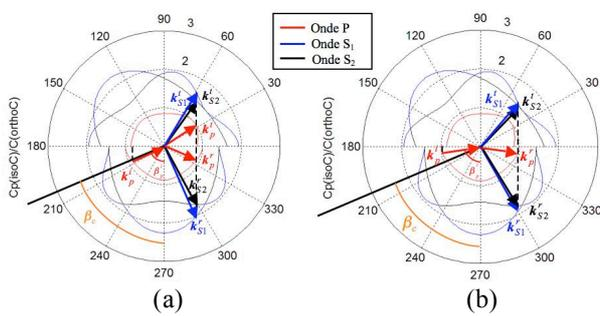
Figure 4 : Phénomènes de réflexion et transmission des ondes à l'interface des deux grains avec la définition de l'angle critique, (a) l'angle incident  $\beta_p^i < \beta_c$  ; (b)  $\beta_p^i > \beta_c$
