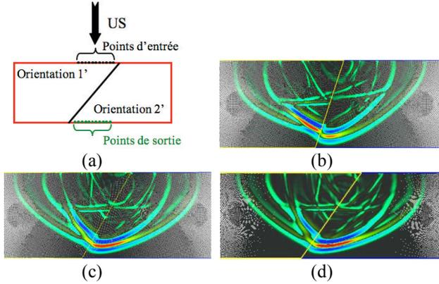
Figure 6 : Influence de l'angle d'incidence sur la transmission d'ondes quasi-P à l'interface : (a) Description de la géométrie du bicristal modélisé, (b)  $\beta_P^i = 72^\circ > \beta_c$ , (c)  $\beta_P^i = 60^\circ < \beta_c$ , (d)  $\beta_P^i = 55^\circ < \beta_c$
