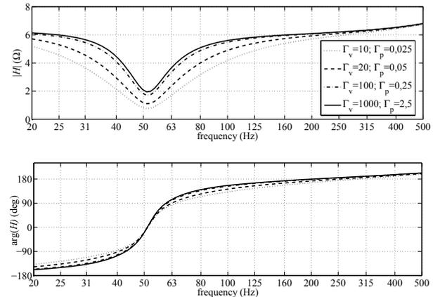
Figure 4 : fonctions de transfert équivalentes calculées avec différentes valeurs de gains de contre-réaction (leur rapport restant constant et  $\Gamma_v$  prenant successivement les valeurs 10, 20, 100 et 1000 V.m/s)
