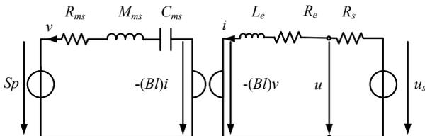
Figure 2 : représentation sous forme de circuit du haut-parleur électrodynamique alimenté par une tension  $U_s(s)$
