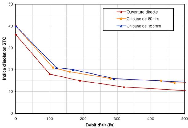
Figure 8 : Corrélation entre les niveaux d'isolation et les débits d'air à 10 Pa, pour la fenêtre ouverte directement ou avec des chicanes de 80 et 155 mm
