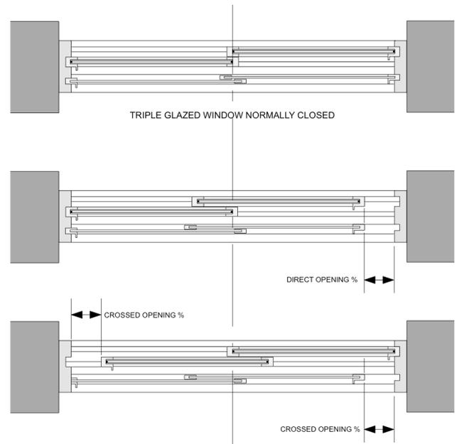
Figure 2 : Configurations d'ouverture (fermée, directe, en chicane) de la fenêtre coulissante à triple verre
