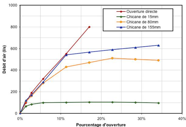
Figure 4 : Comparaison des débits d'air sous une pression de 10 Pa, pour différentes ouvertures de la fenêtre
