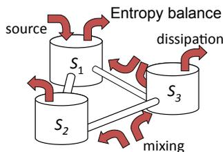
FIGURE 3 – Bilan d'entropie en SEA. Les sources fournissent de l'entropie aux sous-systèmes. Ceux-ci en perdent par les processus de dissipation. Enfin l'échange avec les sous-systèmes voisins génère une entropie de mélange.
