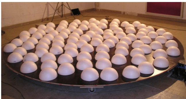
Figure 9 : Diffuseur hémisphérique avec des demi-sphères d'un diamètre de 25cm et un taux de couverture de 50%
