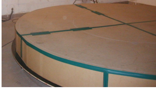
Figure 24 : Diffuseur 3D QRD recouvert d'une plaque de référence.
