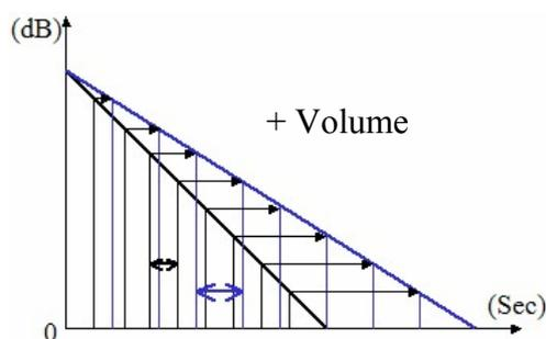
Figure 3 : Le rajout de délai à chaque réflexion provoque un effet d'augmentation de volume [3]
