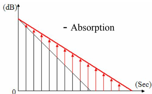
Figure 2 : Le rajout de gain sur chaque réflexion provoque un effet de diminution de l'absorption globale. [3]
