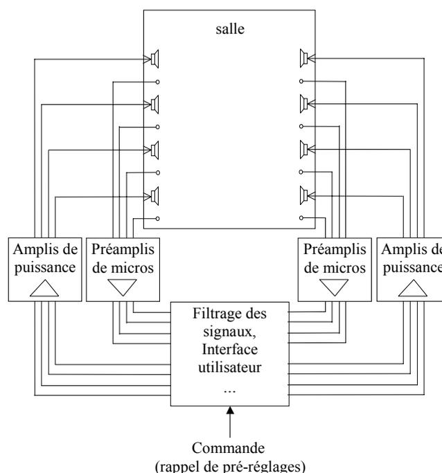
Figure 1 : Schéma général d'un système électroacoustique de contrôle actif de la réverbération [2]
