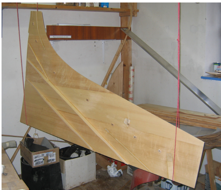
Figure 5 : dispositif expérimental mis en œuvre pour caractériser la table d'harmonie du facsimilé.
