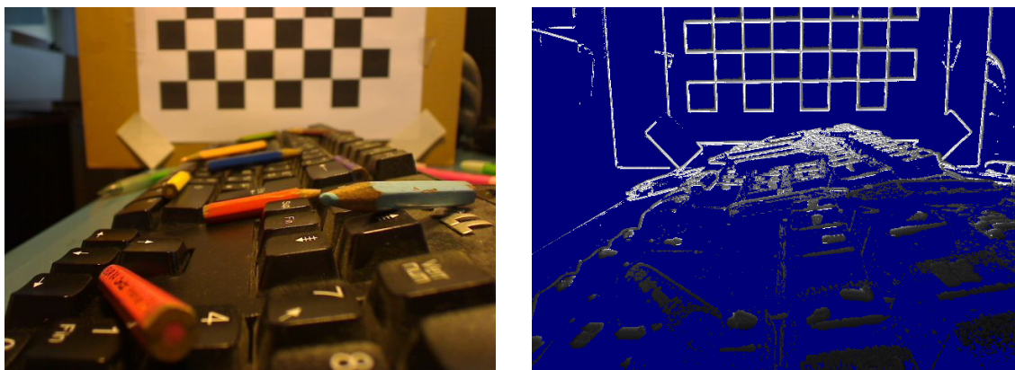
Figure 3: Exemple de détermination de profondeurs. L'échelle de couleurs varie linéairement du noir (2cm ou moins) au blanc (60cm ou plus). Les pixels bleus correspondent aux points rejetés lors du seuillage.
