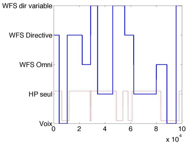
FIG. 5: Extrait de relevé de réponses d'un sujet et de changements objectifs de diffusion. L'axe  $x$  correspond au temps (en ms) et l'axe  $y$  aux modes de diffusion dans le cas des changements objectifs. Les réponses du sujet ne prennent que 2 valeurs, 0 et 1, 0 correspondant à une diffusion perçue comme étant de la voix et 1 pour un système de reproduction
