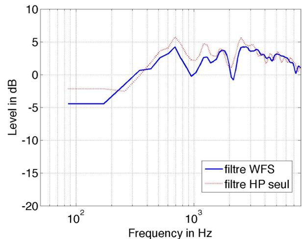
FIG. 4: filtre d'égalisation d'une source virtuelle WFS (resp du haut-parleur) obtenu par différence du spectre moyen de la voix parlée et du spectre moyen de la source WFS (resp du haut-parleur)
