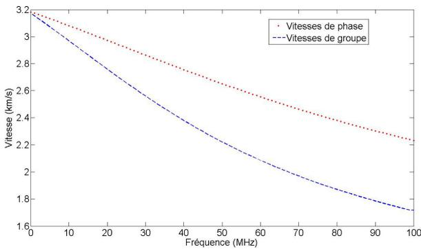
Figure 1 : Vitesses de phase et de groupe pour une couche d'Or de 1  $\mu\text{m}$  sur substrat de verre
