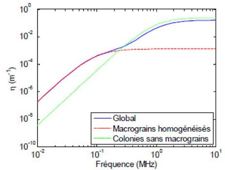
Figure 5. Représentation log-log du coefficient de rétrodiffusion L-L en fonction de la fréquence pour un acier austéno-ferritique avec  $D_m = 10$  mm et  $D_c = 1$  mm dans le cas de macrograins homogénéisés (en rouge), de colonies sans macrograins (en vert) et pris en compte des deux échelles (en bleu).
