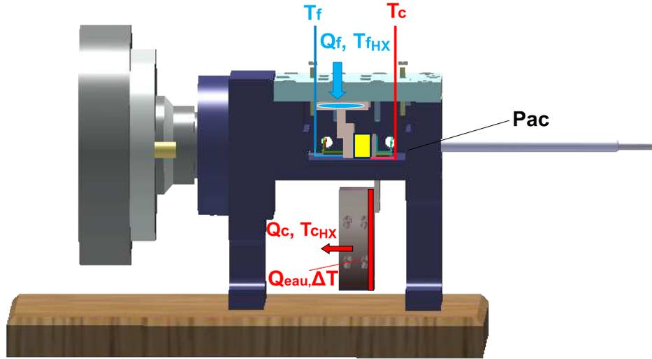
FIGURE 1: Vue schématique du démonstrateur de réfrigérateur thermoacoustique.
