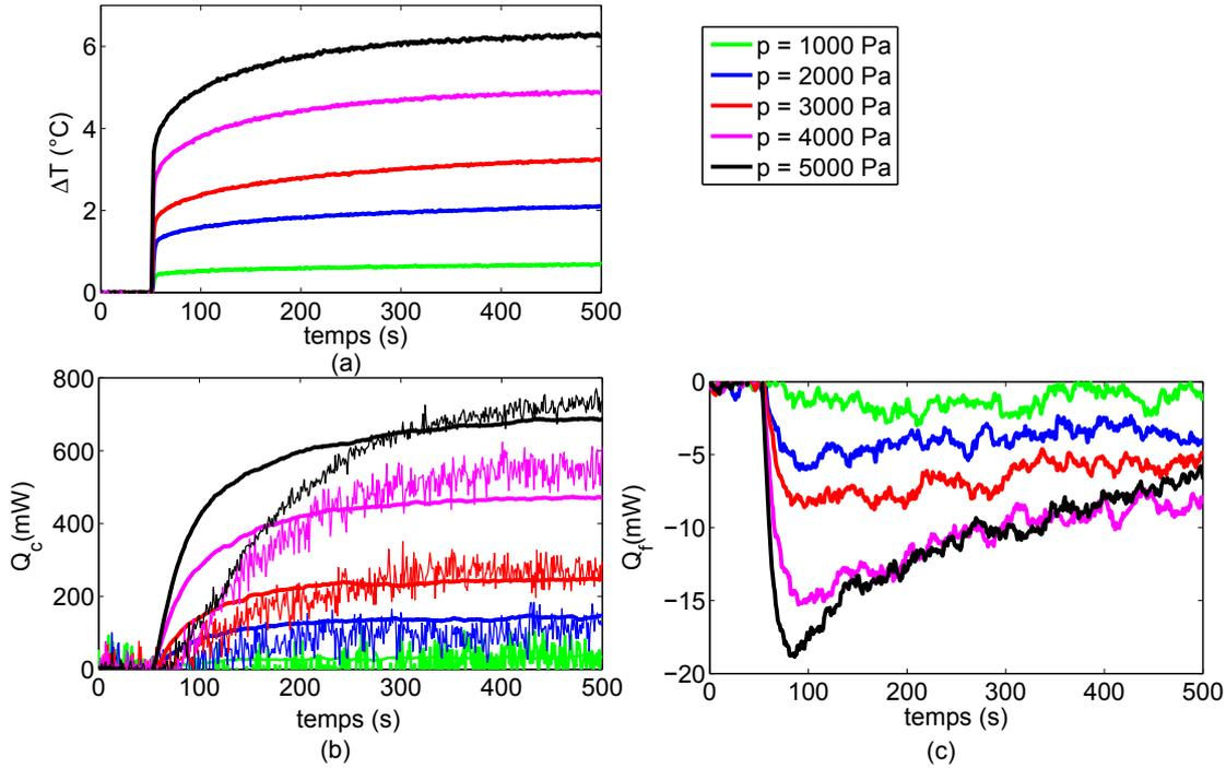
FIGURE 2: Évolution temporelle de la différence de température  $\Delta T$  (a), des flux de chaleur  $Q_c$  (b) et  $Q_f$  (c) rejeté et extrait aux échangeurs de chaleur pour une pression acoustique variant de 1000 Pa à 5000 Pa.
