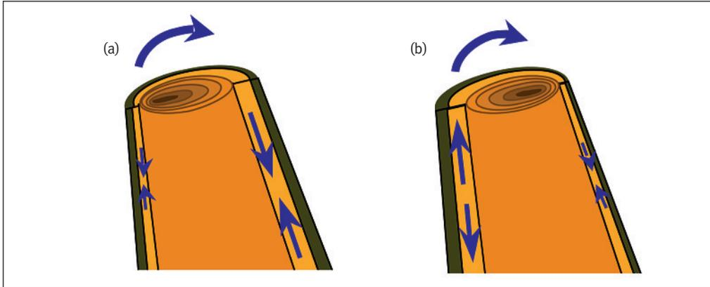
Ce type de réaction modifie le profil des contraintes dans le tronc, d'une part en modifiant la contrainte initiale induite dans le bois juste après sa formation, et d'autre part en créant des mouvements de flexion, et donc des gradients de contrainte dans le tronc, qui s'intègrent au cours de la croissance d'une façon similaire aux mouvements de flexion dus au poids.
