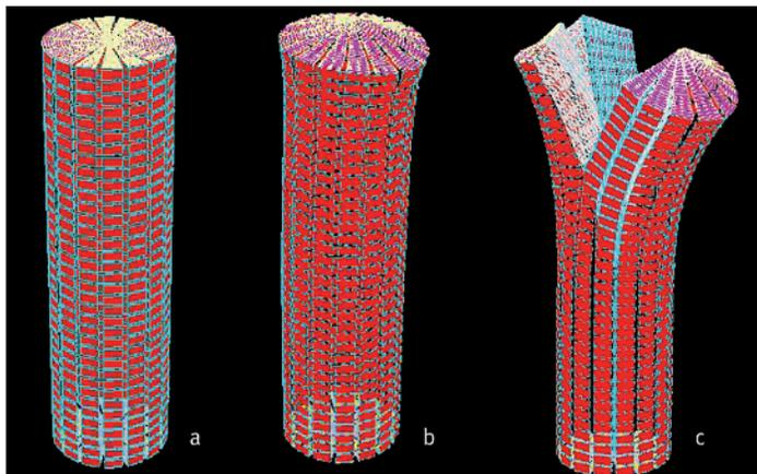
(a) grume dans l'arbre ; (b) après sciage, la section de la grume est bombée à cause de la pré-compression du bois interne et de la pré-tension du bois périphérique ; (c) la libération partielle de ces contraintes crée des mouvements de flexion qui entraînent la propagation des fissures.
