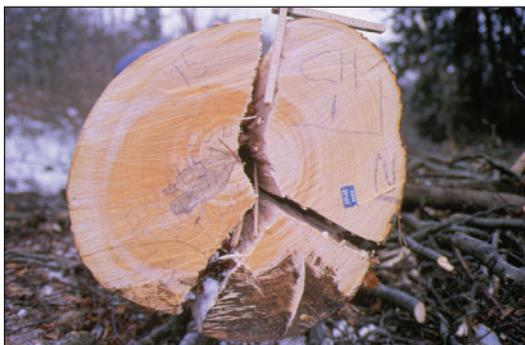
Photo 1 Fente en bout après abattage et déformations au sciage, conséquences directes des contraintes de croissance
