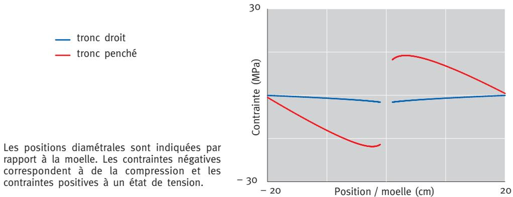
flexions sont d'intensité beaucoup plus importante, et présentent un profil différent, avec de la compression du côté inférieur et de la tension du côté supérieur. Mais ce profil de contraintes est très différent de celui que l'on obtiendrait en fléchissant une structure qui n'est pas en croissance : au lieu d'être maximale au bord et nulle au centre, la contrainte de chaque côté est maximale près du cœur et nulle en périphérie.
