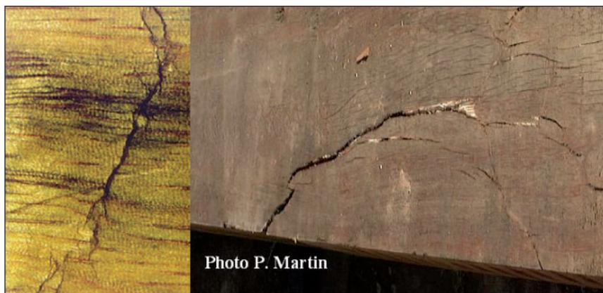
Photo 2 “Coup de vent” dans du bois d’Angélique (*Dicorynia guianensis*, à gauche) et de Saint-Martin (*Hymenolobium spp.* à droite). Ces zones de ruptures en compression, qui ont eu lieu à l’intérieur du tronc sur pied, résultent hypothétiquement d’un trop fort niveau de contraintes de croissance.
