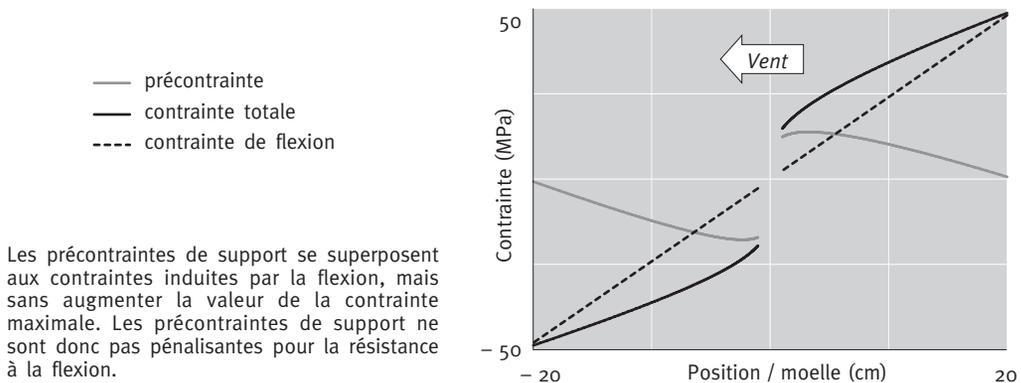
pour résister aux flexions extérieures. L'arbre peut donc supporter des charges supplémentaires comme s'il n'était pas pré-charge par son propre poids, en répartissant efficacement les contraintes sur la section : le poids propre est essentiellement porté par le bois ancien, et les charges extérieures par le bois nouveau, périphérique.
