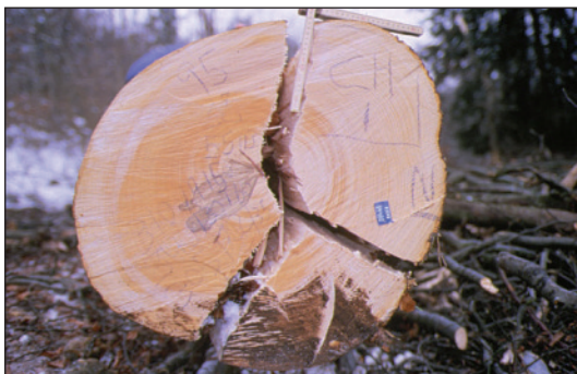
Photo 1 Fente en bout après abattage et déformations au sciage, conséquences directes des contraintes de croissance
