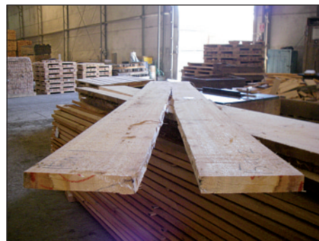
Photo 1 Fente en bout après abattage et déformations au sciage, conséquences directes des contraintes de croissance
