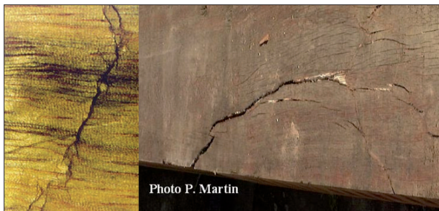
Photo 2 “Coup de vent” dans du bois d’Angélique ( Dicorynia guianensis , à gauche) et de Saint-Martin ( Hymenolobium spp. à droite). Ces zones de ruptures en compression, qui ont eu lieu à l’intérieur du tronc sur pied, résultent hypothétiquement d’un trop fort niveau de contraintes de croissance.
